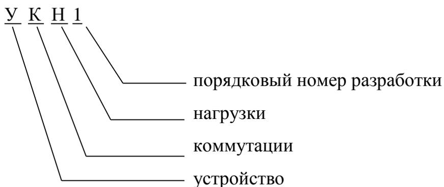
Условное обозначение УКН при заказе и в конструкторской документации другой продукции:
